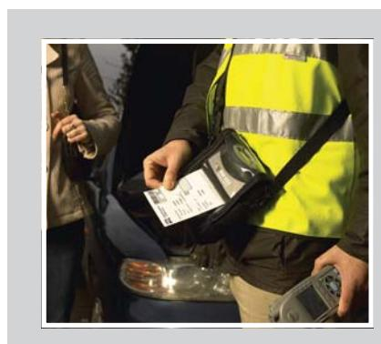
Если принтер RW 420 постоянно используется в кабине автомобиля, Вы можете воспользоваться устройством питания для принтера RW 420 без батареи – принтер будет напрямую получать энергию от аккумуляторной батареи автомобиля, и Вам не придется использовать батарею в принтере, а также зарядные устройства для подзарядки принтера.
